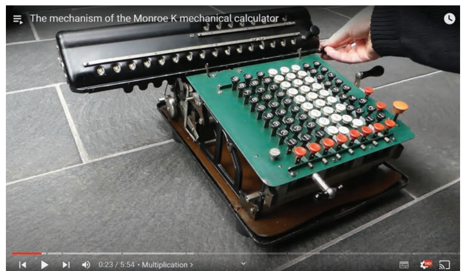
Figuur 4 De oudste en bekendste mechanische rekenmachine is van Pascal. De meest vernuftige is de Curta van Curt Hertzstark. In een Numberphile -video vertelt Alex Bellos er meer over. De Monroe K-rekenmachine stamt uit 1921 en is gebaseerd op de rekenmachine van Leibniz. In een YouTube-video laat Jaap zien hoe deze machine in elkaar zit.
